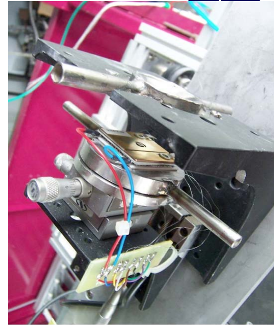
Convertisseur hybride CPV-TE placé au foyer du concentrateur
