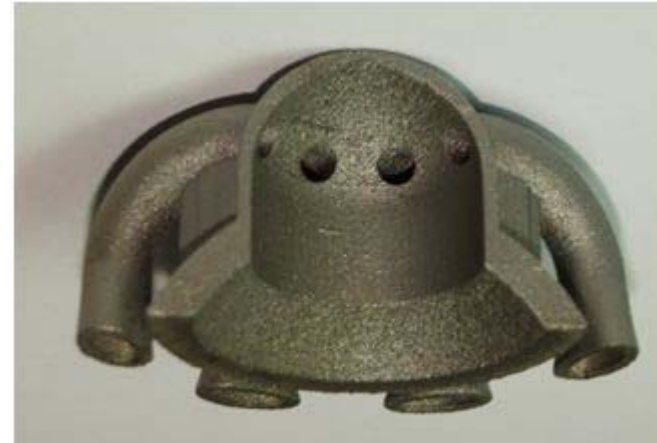
Photographie Tête chaude obtenu par fusion laser
