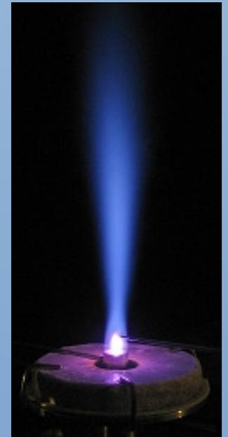
Combustion assistée par plasma ; flamme prémélangée de propane/air de 12 kW (richesse = 0.8) sans et avec plasma. (source : EM2C <http://www.em2c.ecp.fr>)
