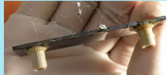
Instrumentation par des \mu thermocouples (type K, 20 \mu m ou 50 \mu m).
